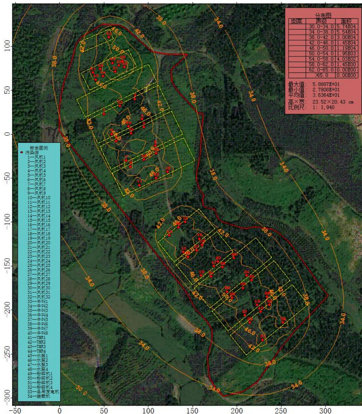
图 4.5-1 本项目噪声贡献值等声值线图 单位: dB (A)
